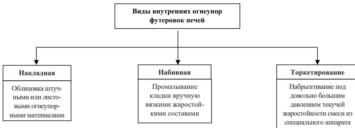
Огнеупорная футеровка доменной печи предназначена для значительного уменьшения тепловых потерь и предохранения кожуха от воздействия высоких температур, а также от контакта с жидким металлом и шлаком. В составе огнезащитных облицовок используются различные слоисто-пористые материалы и изделия на их основе. Данный материал устойчив к пожару и имеет высокие показатели теплостойкости и огнеупорности, плохо вступает в химические реакции, имеет высокие изоляционные свойства.
