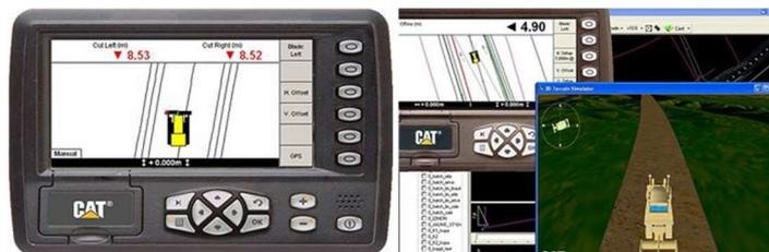
Рис. 1. Система нивелирования для бульдозеров
