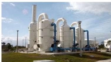
Рис. 2. Химический жидкостный скруббер
