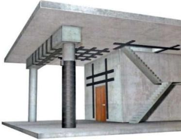
Рис. 3. Места укрепления композитными материалами зданий и сооружений
