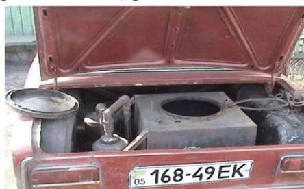
Рис. 2. Газогенератор в багажнике автомобиля
