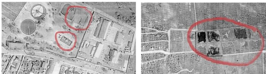
Рис. 4. Приемная камера, песколовки, иловые площадки Южных очистных сооружений канализации (Золотой Затон)
